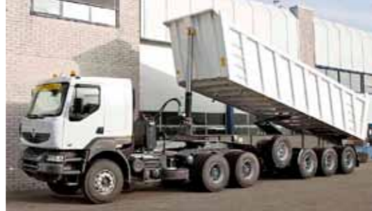
Maamassojen kuljetukseen varusteltu Kerax (6x4) tukevine kippiperävaunuineen. Moottori 480 hv, kok.paino 48 tn ja työmaa-alueella todennäköisesti paljon enemmänkin.
