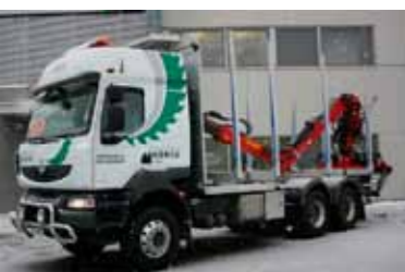
Puutavarankuljetukseen varusteltu korkeahyttinen Kerax (6x4) nostureineen kaikkineen. Moottori 520 hv, yhdistelmän kok.paino 60 tn.
