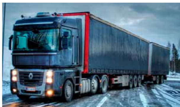
Magnum (6x2*4) maksimipituinen 25,25 m:n puoliperävaunun ja keskiakseliperävaunun yhdistelmän vetotehtävissä. Moottori 520 hv, kok.paino 60 tn.
