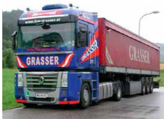
Rekkamiehen pitkän matkan koti Magnum (4x2) tyypillisessä käyttötarkoituksessaan puoliperävaunun veturina. Moottori 440 hv, yhdistelmän kok.paino 44 tn.
