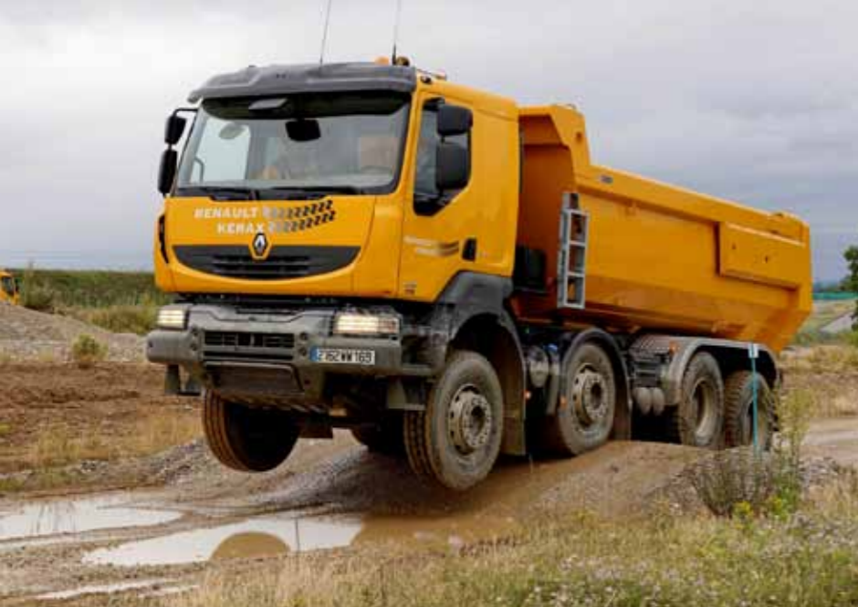
Kerax (8x4) rämpimässä savi-kossa tukevalla kiviaineslavalla varustettuna. Moottori 460 hv, kok.paino 32 tn.
