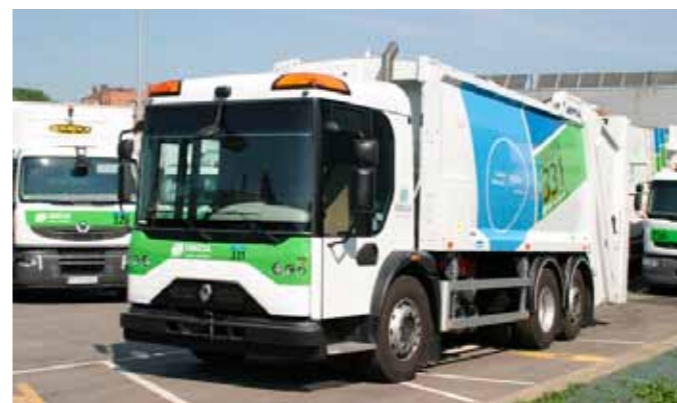
Aiempaa jo tuotannosta poistunutta, käyttötehtävänsä täsmäsuunniteltua erikoiskalustoa: Renault Puncher (6x2*4). Tarkoituksenmukainen on kaunistaa! Moottori 320 hv, kok.paino 26 tn.
